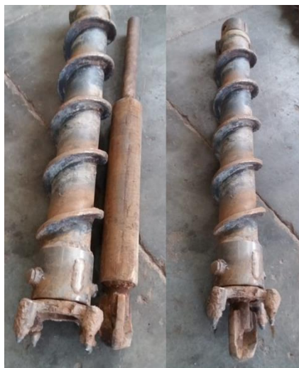
Figura 10. Trados Ocos Helicoidais com ferramenta interna de corte, fora dos trados (esquerda) e colocada dentro dos trados (direita)
