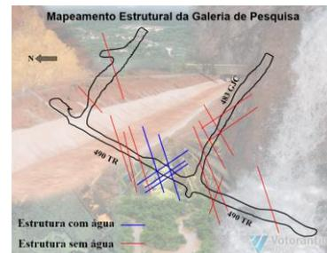
Figura 2, 3 e 4: Mapeamento Estrutural (Falhas/fraturas)
