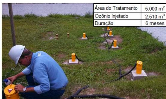
**Figura 1** Poços e injeção e volume injetado
