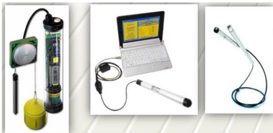
Figura 3 – Equipamentos que realizam as medições a cada hora do nível estático nos poços da Rede RIMAS.
