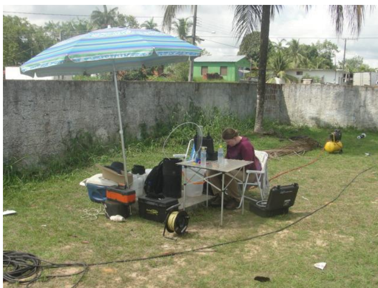
Figura 5 – Coleta de amostras de água através do método “low flow”
