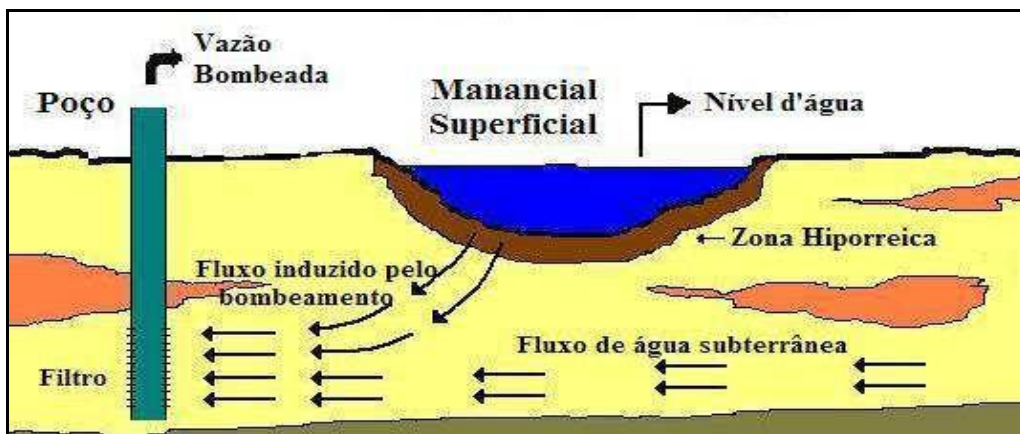
Figura 1 - Esquema simplificado da técnica de Filtração em Margem.
