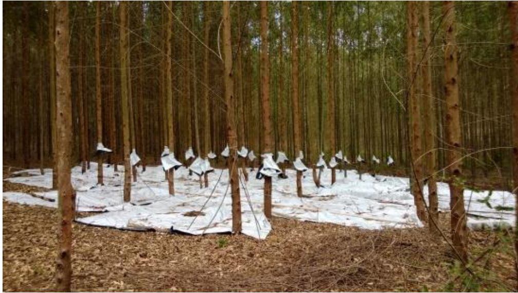
Figura 4. Impermeabilização da superfície e cones invertidos nos troncos dos eucaliptos
