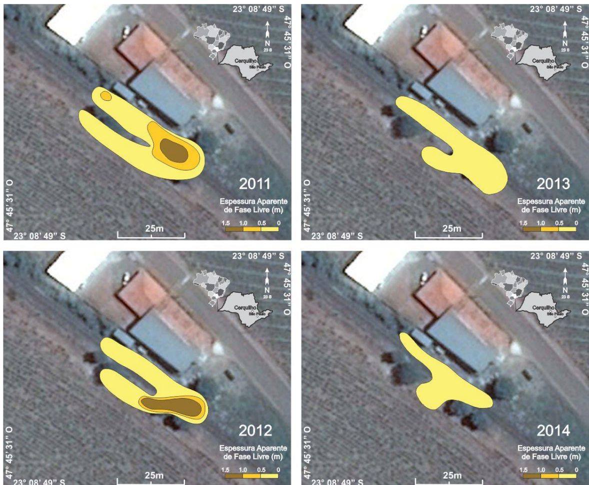
Figura 2. Evolução da pluma de contaminação de 2011 a 2014 em valores de espessura aparente de fase livre. Fonte: Autor
