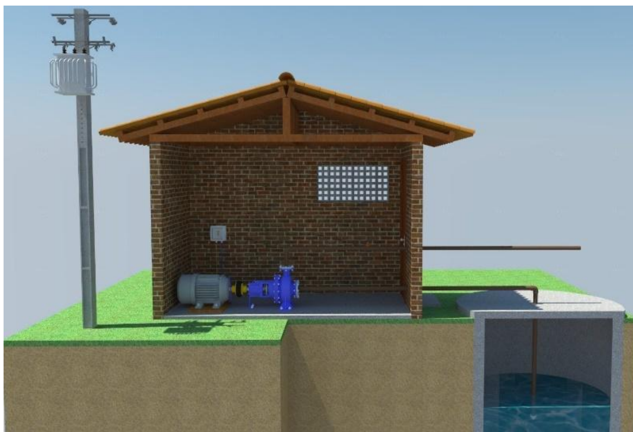
Figura 3. Esquematização de instalação de bomba centrífuga
