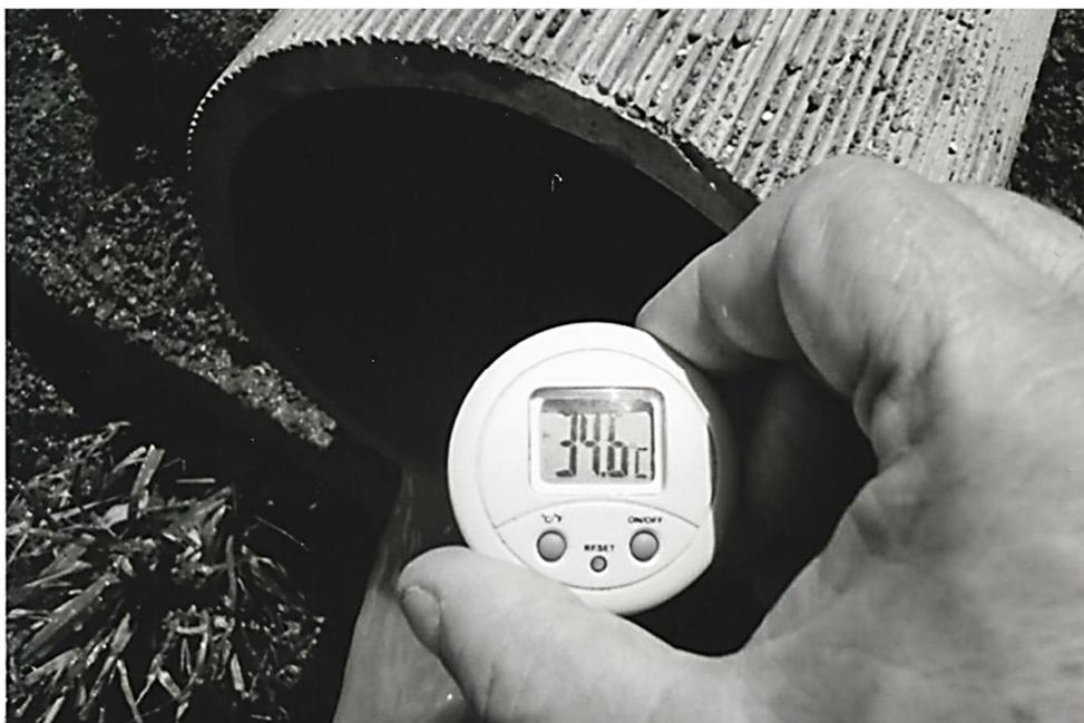
Figura 10: Temperatura da água medida na fonte 34,6°C e durante o desenvolvimento do poço com ar comprimido.
