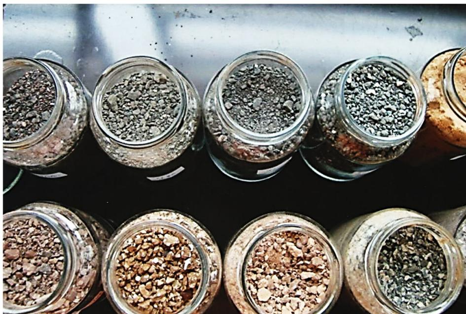
Figura 11: Amostras coletadas durante a perfuração. Colorações cinza amostras dos derrames basálticos e colorações laranjas os Arenitos Botucatu.
