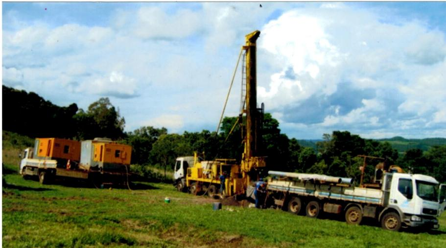
Figura 5: Equipamento de perfuração e geradores
