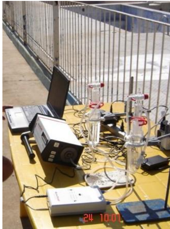
Figura 1: Aparelho Alpha Guard montado para análise das amostras de água. Figure 1: Alpha Guard unit mounted for analysis of water samples.
