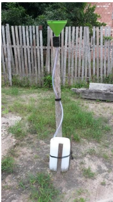
Figura 01. Pluviômetro artesanal instalado na área do microssistema de abastecimento público do Urumari. Foto: Lucas Meireles.
