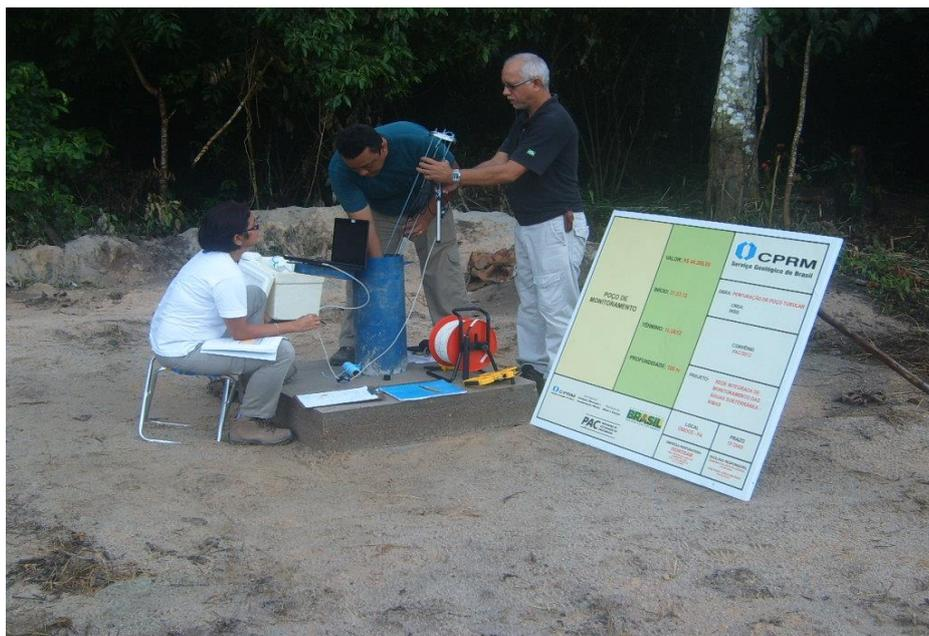
Figura 4. Instalação de medidor de nível automático em Óbidos (Baixo Amazonas)
