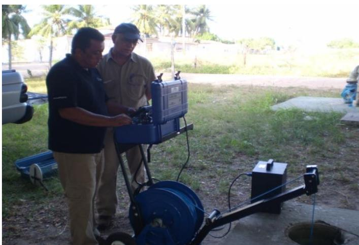
Figura 6. Perfilagem óptica do poço Barreiro em Salinópolis, nordeste do Pará
