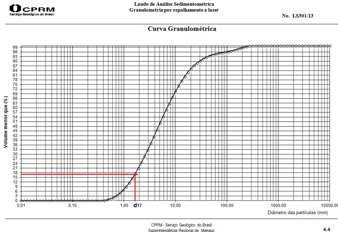
Figura 5: Curva granulométrica resultante da análises realizadas no LAMIN-CPRM.
