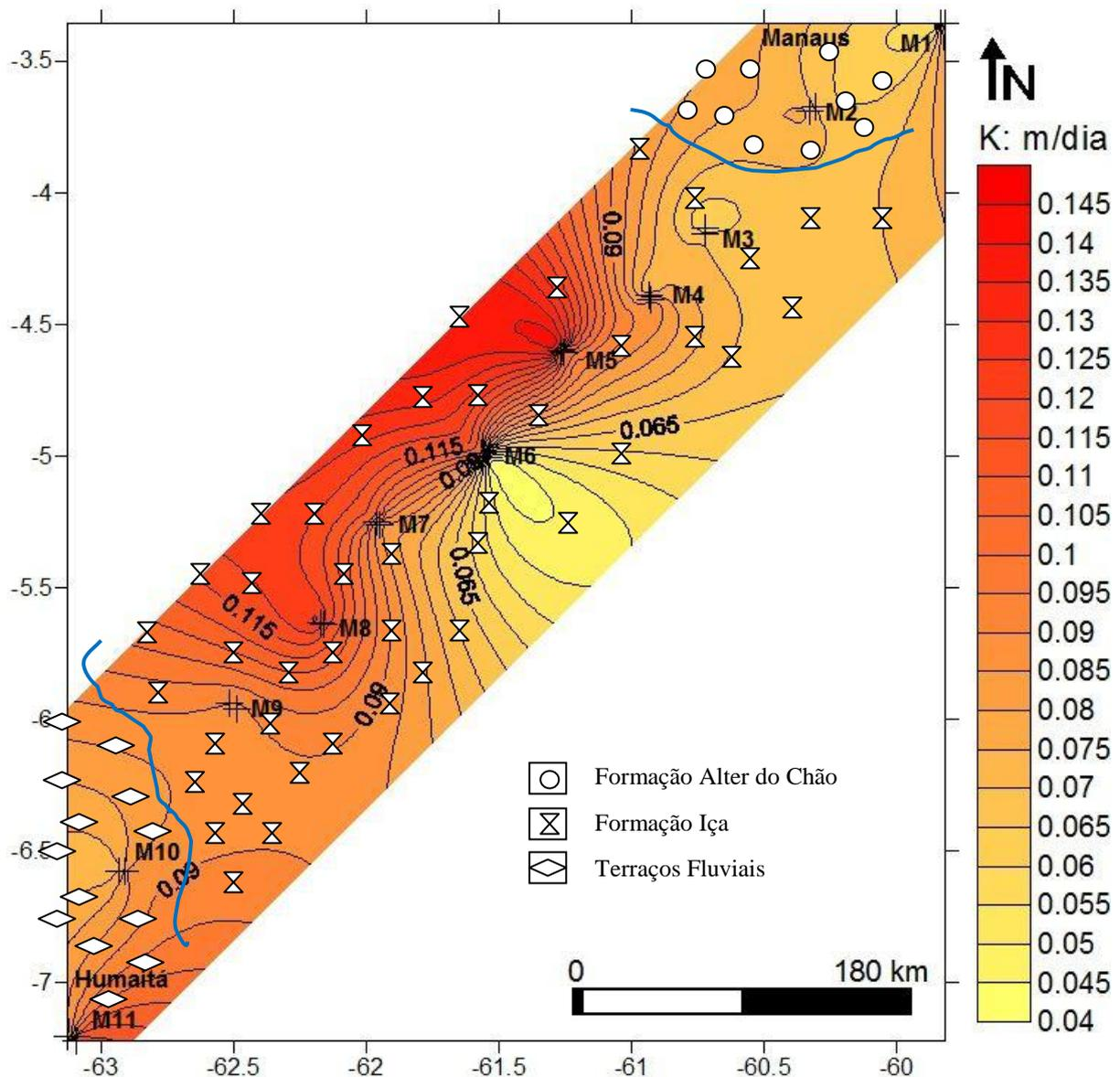
Figura 7: Mapa condutividade hidráulica (K) ao longo da BR-319, trecho Manaus – Humaitá-AM. Representando os valores de K em mapa de isolinhas interpoladas, indicando zonas de diferentes valores de K.
