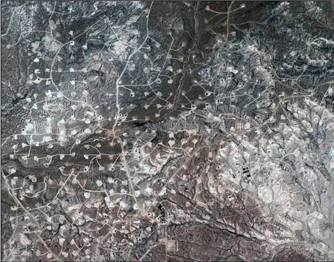
Figura 2: Centenas de poços interligados por estradas dedicadas para o transporte de água, produtos químicos, fluido e salmouras retornadas da perfuração, e do próprio gás produzido. Fonte: http://aspo-deutschland.blogspot.com.br/2012_07_01_archive.html
