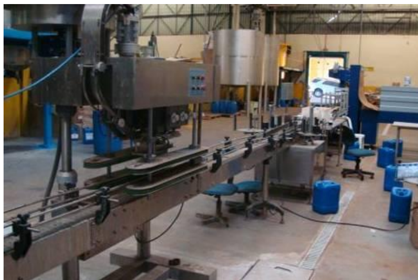
FIGURA 07: ENVASE E ROTULAGEM DOS PRODUTOS
