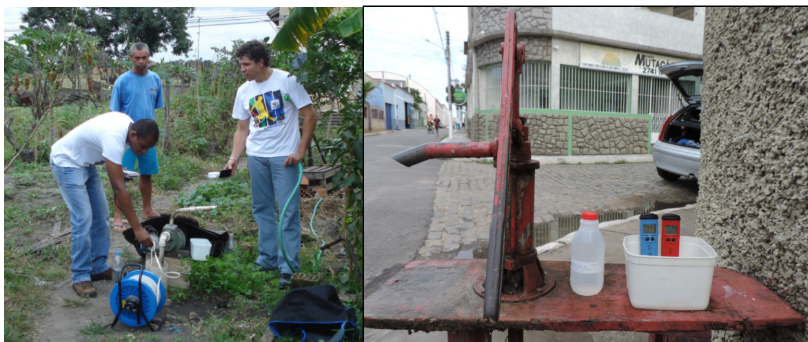
Figura 3 – Cadastramento dos poços rasos. Medição do nível d'água Medição da condutividade elétrica, sólidos totais dissolvidos, pH e temperatura.
