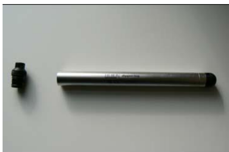
Figura 2a e 2b. Registrador de dados (dipper log) e Suporte e cabo de leitura do Loggers
