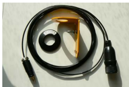
Figura 2a e 2b. Registrador de dados (dipper log) e Suporte e cabo de leitura do Loggers
