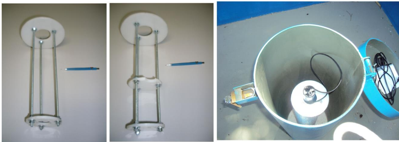
Figura 3 - Suportes de proteção para sustentar os equipamentos dentro do revestimento do poço. Para cada tipo de equipamento, existe um modelo de suporte.
