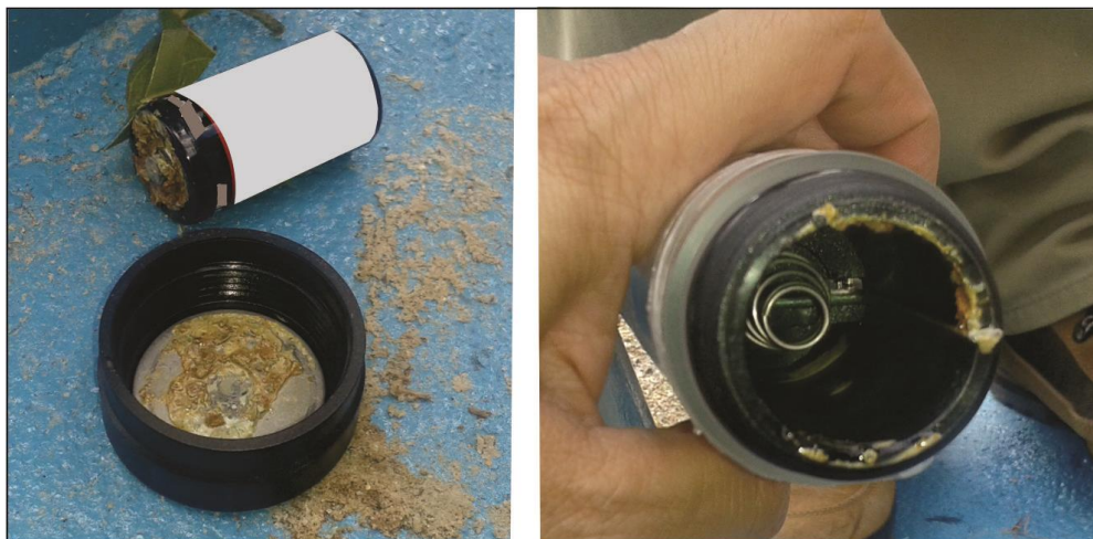
Figura 1 - Visualização do compartimento de pilha em um equipamento, após vazamento de líquido da mesma.
