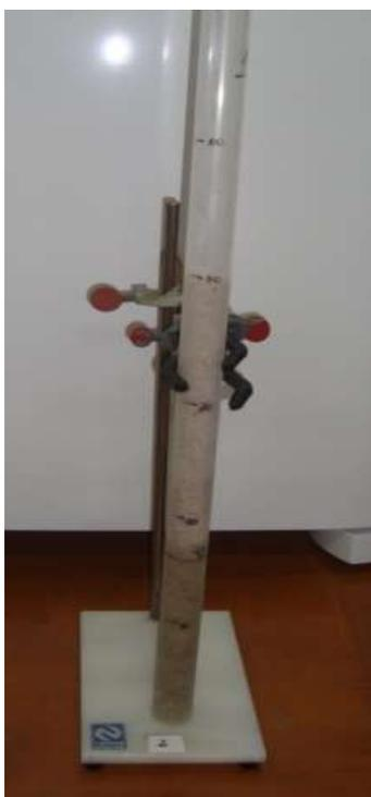
Figura 2 - Coluna de acrílico utilizada nos experimentos montada em suporte universal
