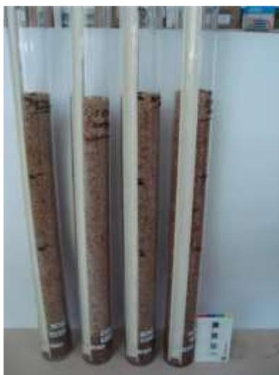
Figura 1 - Colunas de acrílico fixadas sobre a bancada do laboratório.
