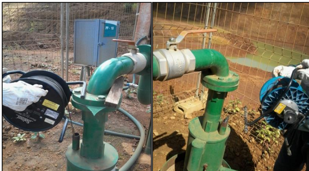
Figura 12 – (esq.) Monitoramento do nível utilizando o medidor nível elétrico / (dir.) Retirada semanal do micro-diver para baixar os dados lidos continuamente (Fonte: Vale Fertilizantes).
