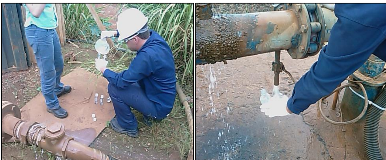
Figura 13 – Amostragem durante campanha hidrogeoquímica dos poços da mina F4 (Fonte: Vale Fertilizantes).
