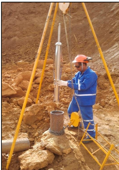
Figura 21 – Descida de parte da aparelhagem utilizada para filmagem ótica do PP-13 na mina F4
