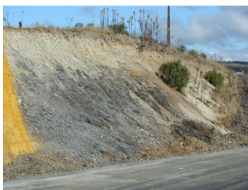
Figura 13 - Folhelhos cinza escuros alterados e com intensa fissilidade da Unidade Hidroestratigráfica Serra Alta, na BR-282 no município de Lages.
