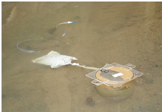
Figura 2 – Ensaio de infiltração na zona hiporreica, rio Beberibe, Pernambuco, Brasil.
