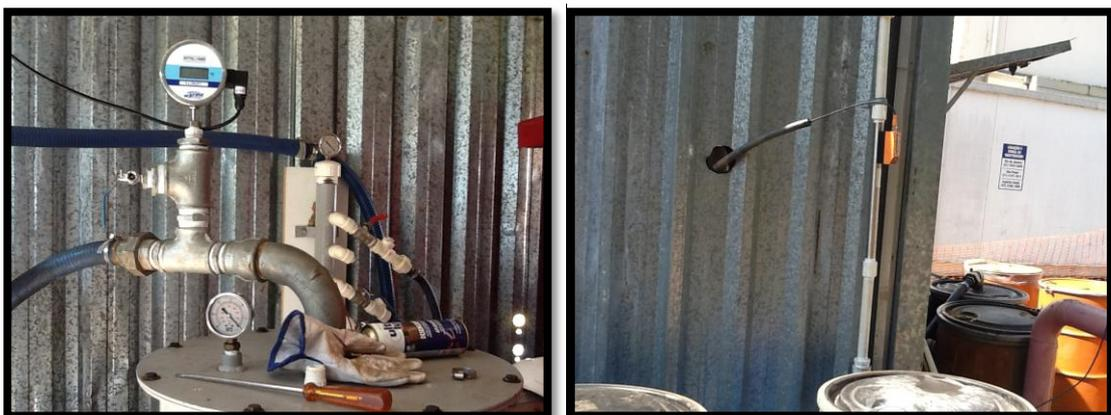
Figura 3 – Sensores de temperatura e vazão de ar em operação durante um teste.
