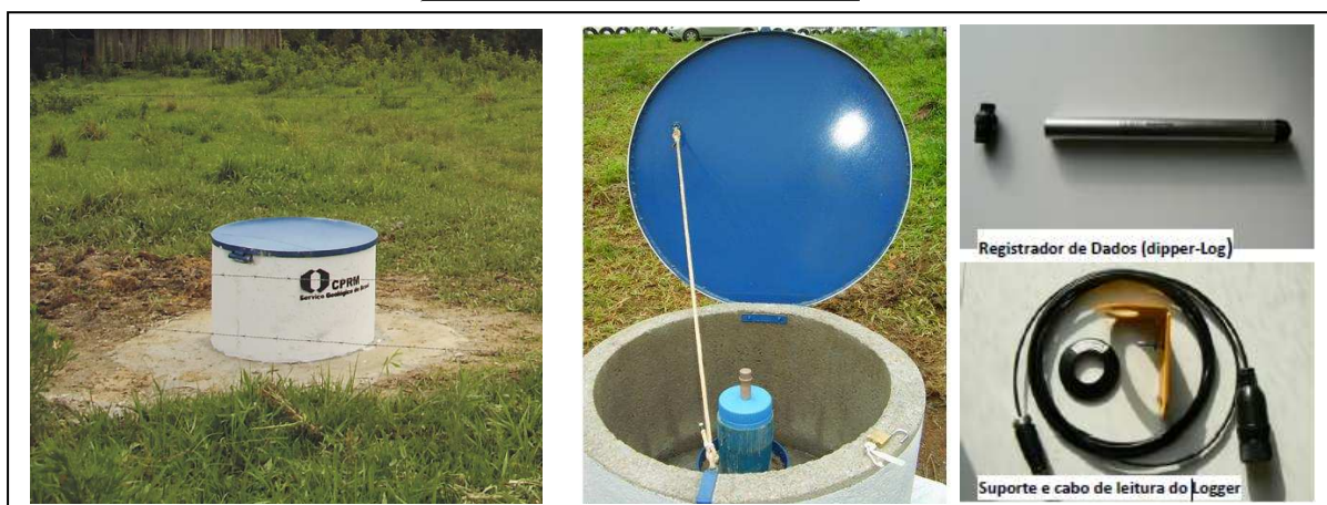
Figura 2 – Acabamento final dos poços e registrador de dados Dipper-log.
