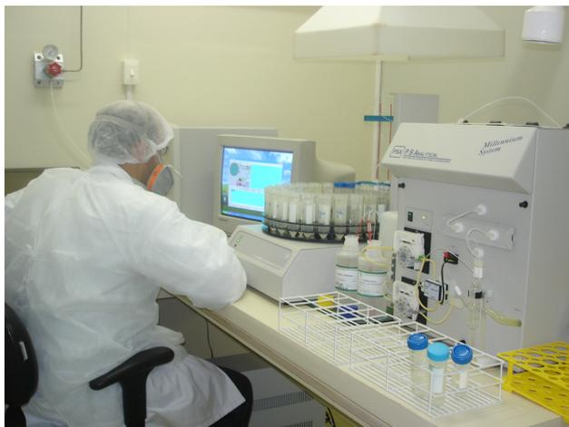
Figura 2 - Espectrômetro de Fluorescência Atômica do Vapor Frio (CVAFS).
