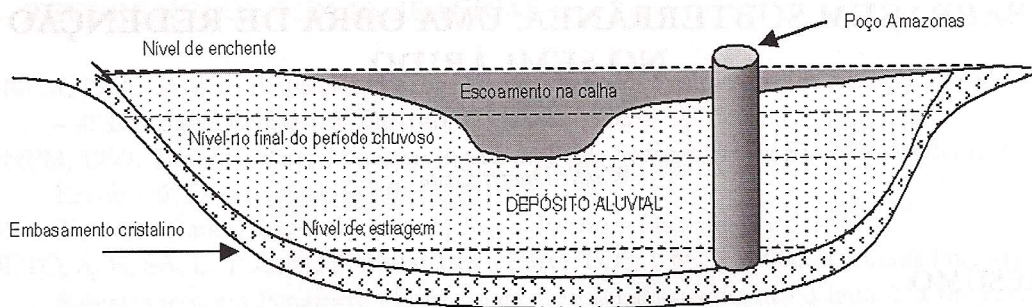
Figura 1 – Rebaixamento do nível da água nos depósitos aluviais
