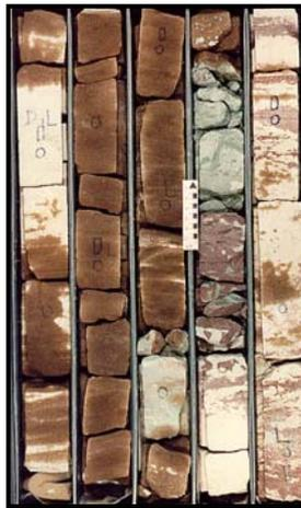
Figura 3. Testemunhos de reservatórios siliciclásticos produtores de petróleo na Fm Açu.
