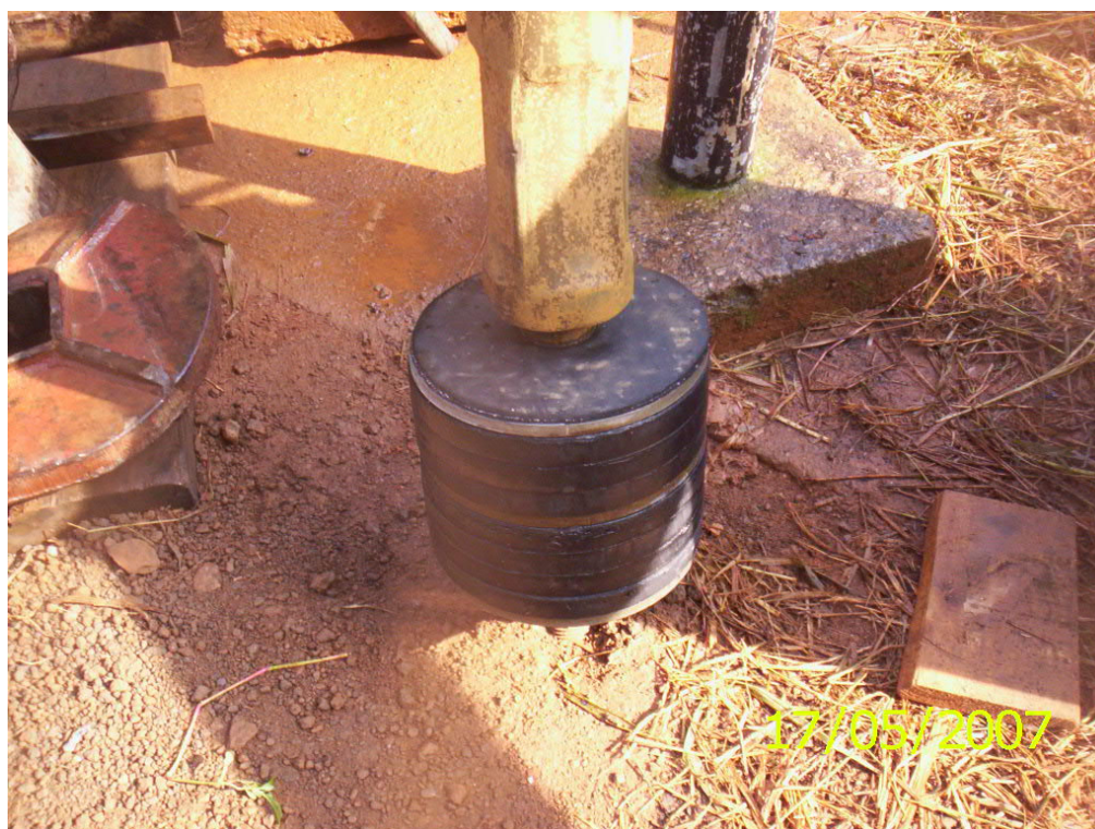
Figura 6. Detalhe do pistão (êmbolo) utilizado
