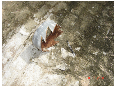
Figura 04 – Ferramentas utilizadas para romper o fundo do revestimento do poço.
