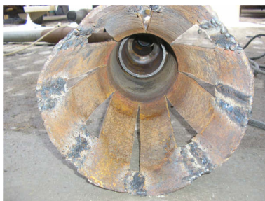
Fig. 1 – Aba para assentar na extremidade superior da haste perdida
