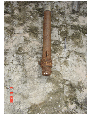
Figura 08 – Pescador interno de tubulações com dois mecanismos laterais que permitem travar a sua saída. Alguns mecanismos guias (figura central) permitem a verticalização do pescador.
