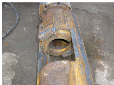
Fig. 4 – Peça denominada morsa que serve para aprisionar a haste caída no poço, uma vez que está é capturada pelo rabo de tatu (fechada).
