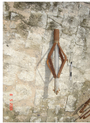
Figura 08 – Pescador interno de tubulações com dois mecanismos laterais que permitem travar a sua saída. Alguns mecanismos guias (figura central) permitem a verticalização do pescador.
