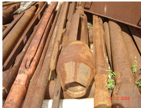
Figura 05 – Pescador interno ao revestimento, construído a partir de um percussor.
