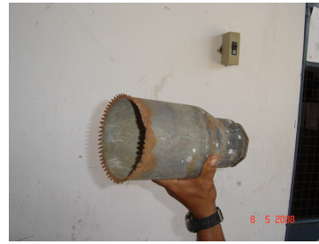
Figura 04 – Ferramentas utilizadas para romper o fundo do revestimento do poço.
