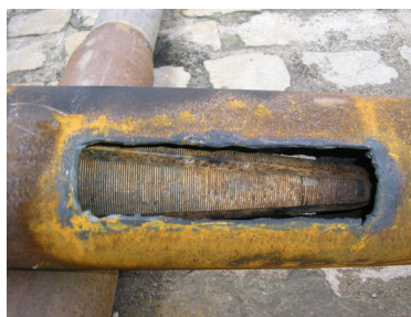
Fig. 2 – Peça rosqueada, tipo “rabo de tatu” para se tentar acoplar esta à rosca fêmea superior da haste perdida
