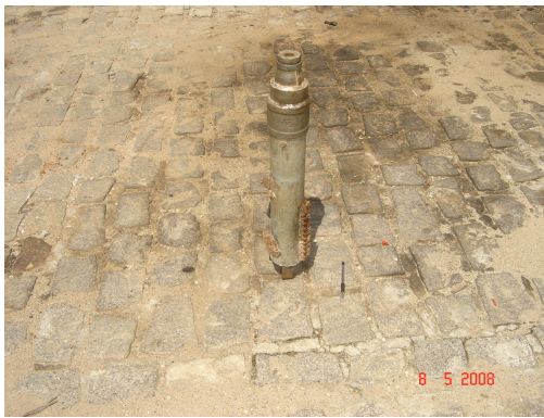
Figura 08 – Pescador interno de tubulações com dois mecanismos laterais que permitem travar a sua saída. Alguns mecanismos guias (figura central) permitem a verticalização do pescador.
