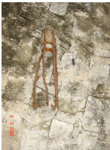
Figura 6 – Pescador de cabo elétrico da bomba (CAERN).
