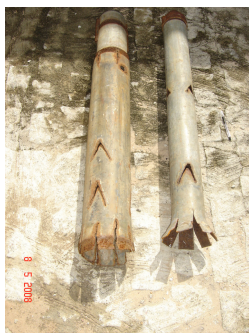
Figura 11 – Pescador de bomba submersa em formato de manga para agarrar os estágios da mesma.
