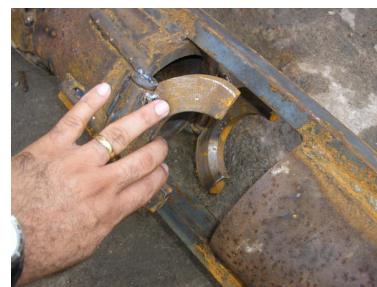
Fig. 3 – Peça denominada morsa que serve para aprisionar a haste caída no poço, uma vez que está é capturada pelo rabo de tatu (aberta).
