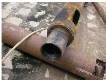
Fig. 5 – Haste inferior a partir da qual são acopladas todas as outras para a realização da pescaria.
