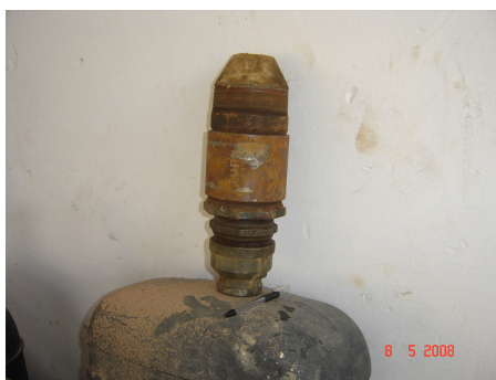
Figura 07 – Ferramenta guia para pescar coluna de bomba.
