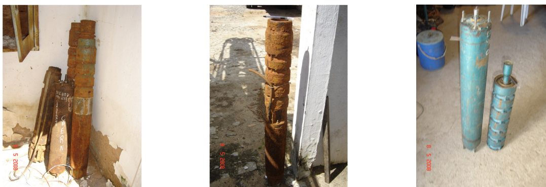
Figura 10 – Comparação entre bombas submersas corroídas pela acidez da água com aquela em perfeito estado (fig. da direita), esta mostrando o motor e o seu bombeador, onde ficam os rotores.
