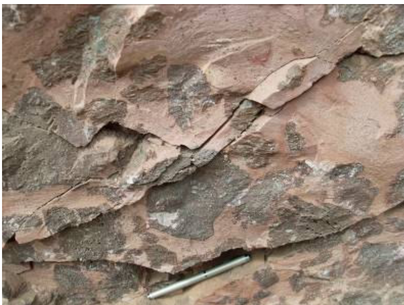
Figura 3: Brecha “peperítica” no contato entre derrames da Serra Geral, revelada na escavação da casa de força da UHE Foz do Chapecó, no rio Uruguai. Maio de 2008. (Foto Luiz Fernando Scheibe).
