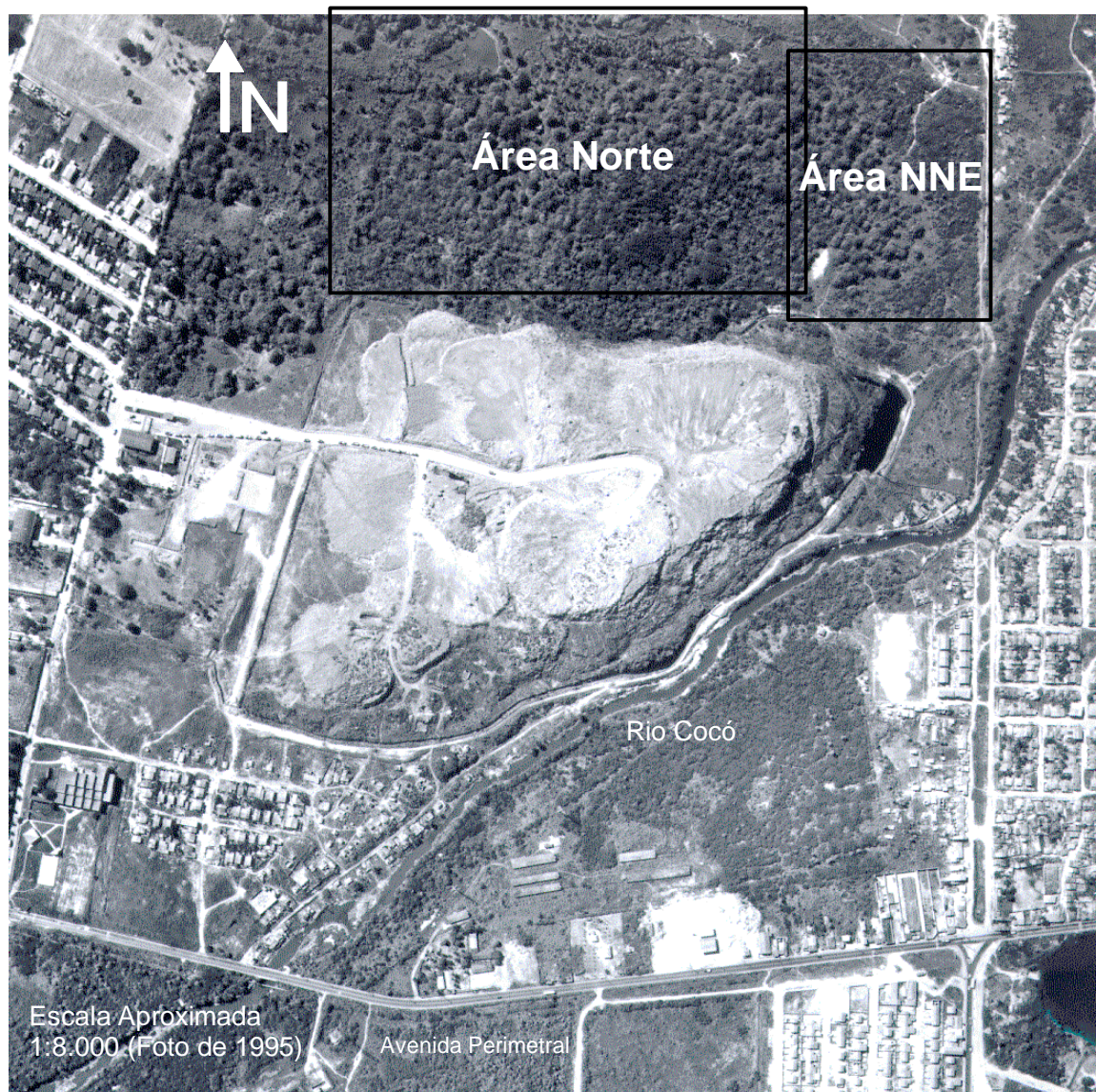
Figura 4 . Localização das áreas do mapeamento eletromagnético indutivo. Área norte (N) com cotas entre 16 e 12 metros, e setor NNE topograficamente mais deprimido.
