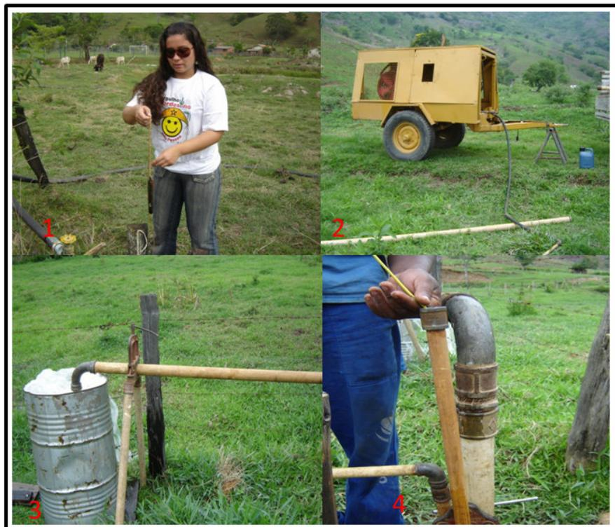
Figura 6.: 1) Instalação do *Diver* no poço de observação; 2) Compressor; 3) Monitoramento da vazão durante o teste e 4) Monitoramento do nível dinâmico com medidor elétricos nos poços de bombeamento.
