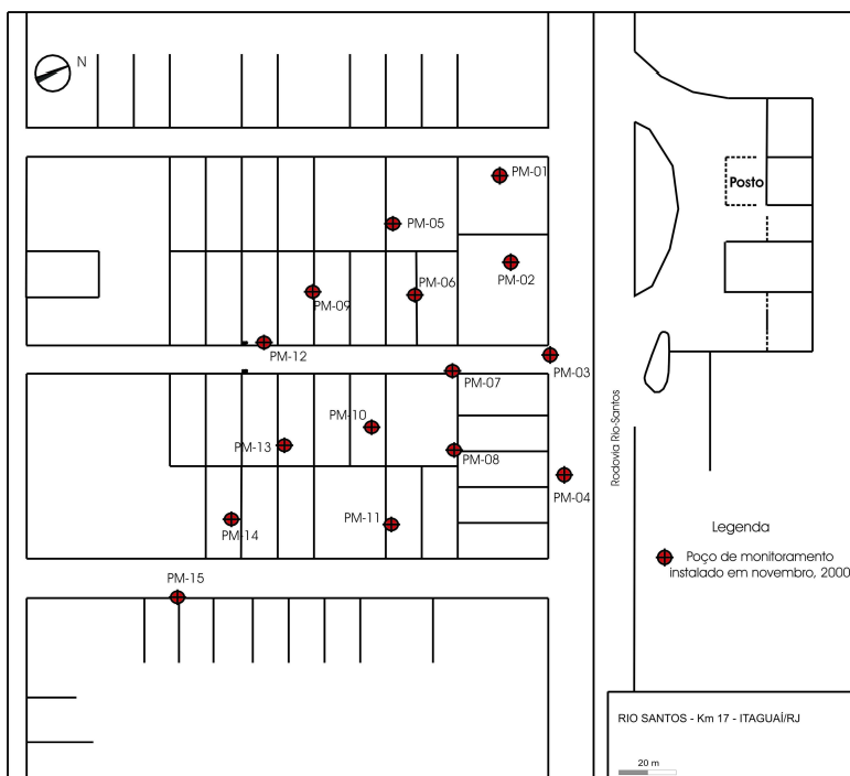
Figura 2. Poços de monitoramento instalados na etapa 1, em novembro de 2000.
