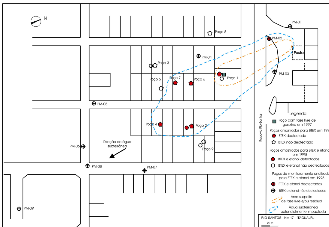
Figura 1. Poços amostrados para BTEX e etanol no período de 1997 e 1998
