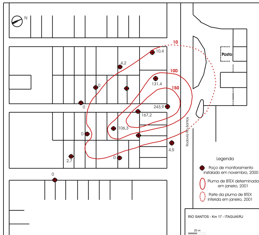
Figura 3. Pluma de contaminação de BTEX determinada no mês de janeiro, 2001. Contornos da pluma de BTEX são de 10, 100 e 150 mg/L. São apresentadas as concentrações de BTEX em cada poço para a profundidade de 1,5 m
