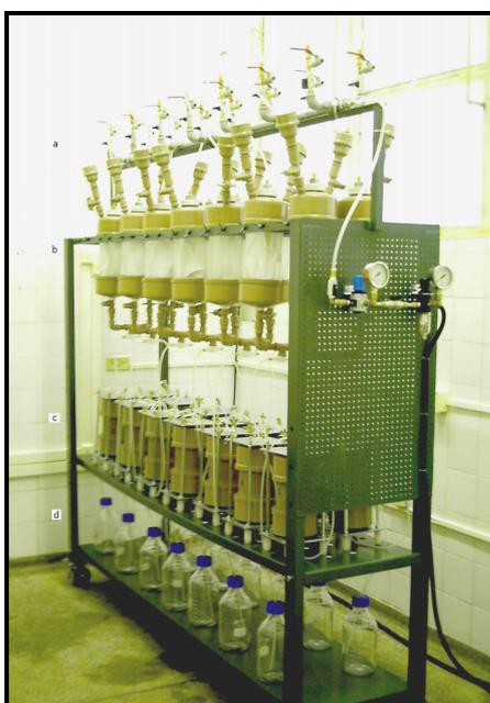
Figura 2. Sistema de percolação em colunas, composto de: a) Distribuidor de ar, b) pares de reservatório; c) colunas de percolação e d) frascos coletores
