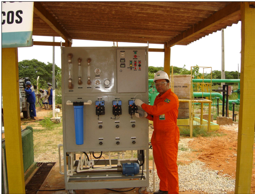
Figura 3. Protótipo de nanofiltração / osmose inversa do CENPES operando em Fazenda Belém.
