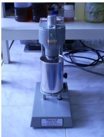
Figura 3. Viscosímetro Fann modelo 35 A.
