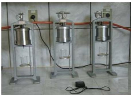
Figura 5. Filtro prensa da marca Fann.
