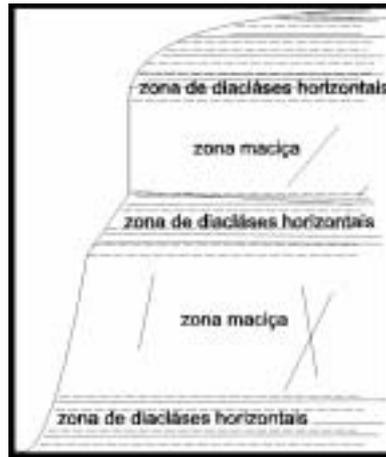
**Figura 5** - Perfil esquemático das principais estruturas primárias dos fluxos ácidos do Sistema Aquífero Serra Geral
