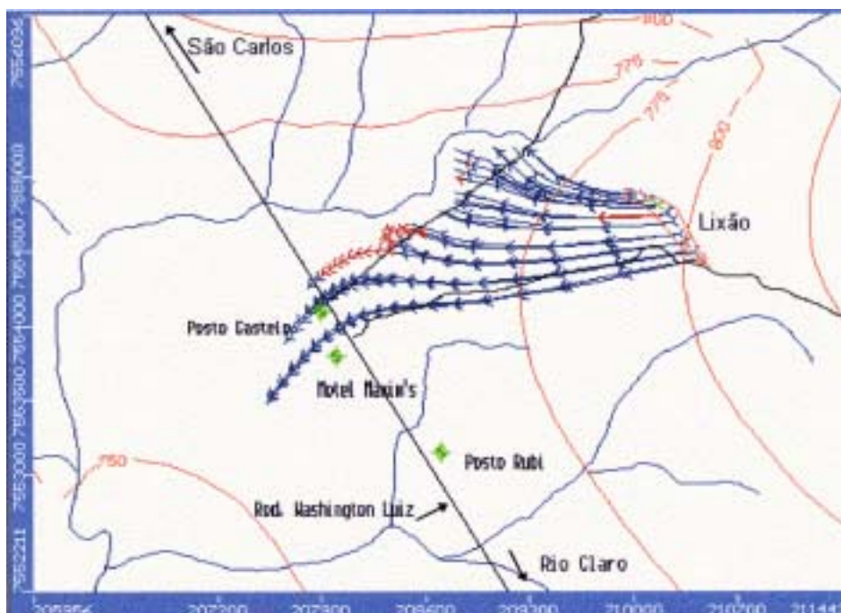
Figura 6 – Trajetórias obtidas para a pluma pelo FDM. Gráfico produzido no Visual Modflow 95 ®
