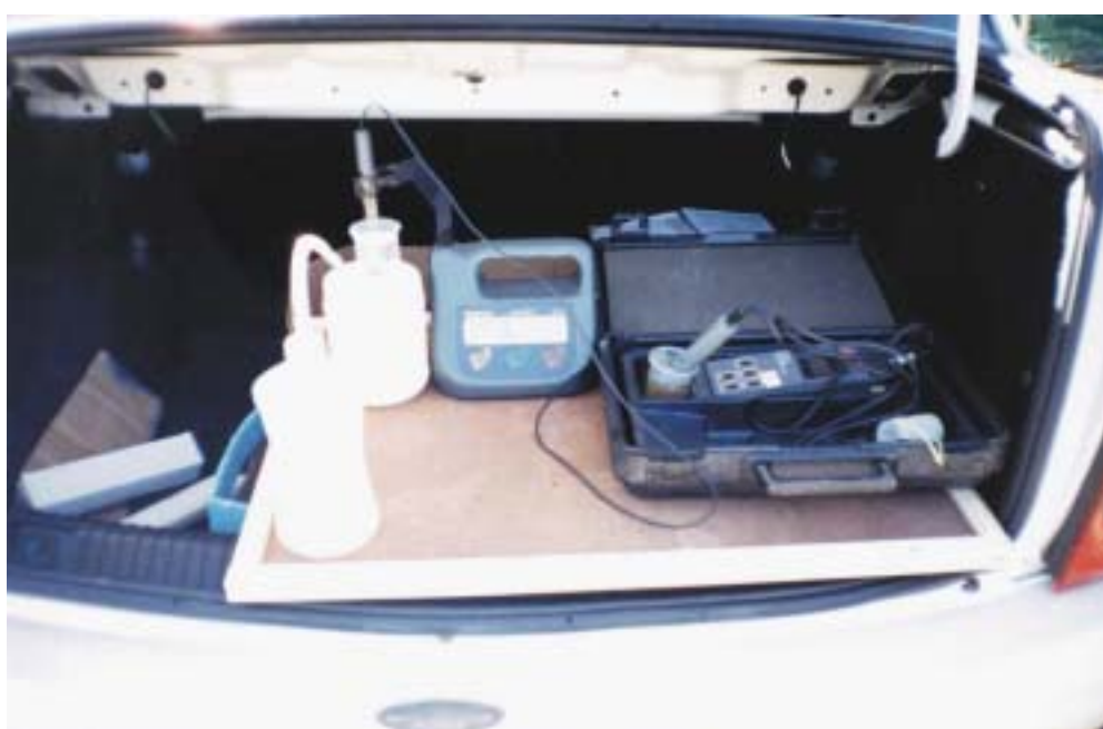
Figura 3 – Laboratório móvel constituído por medidor de pH e condutivímetro
