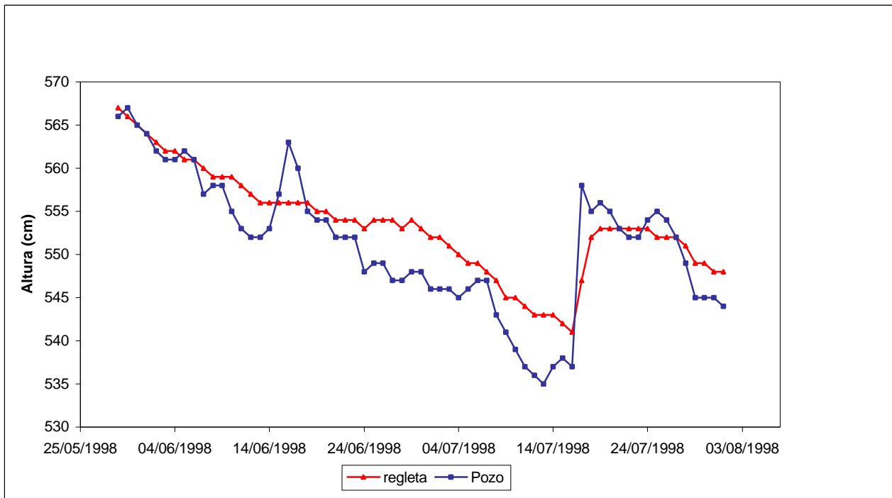
Figura 4. Detalle de variación para un período en que el nivel freático supera a la laguna.
