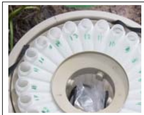
Foto 9 – Detalhe do interior do coletor automático, contendo 24 garrafas para amostras.
