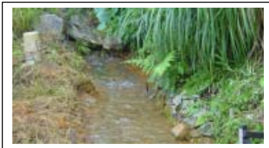
Foto 5 – Surgência do Tadinho, vazão de 48 L/s, observe-se coletor automático e régua limétrica.
