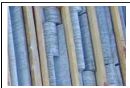
Fotos 1 e 2 – Testemunhos de cálcio filito típico apresentando-se bastante foliado
