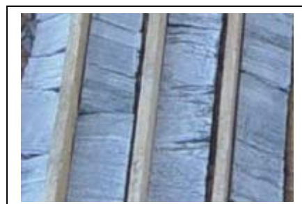
Fotos 1 e 2 – Testemunhos de cálcio filito típico apresentando-se bastante foliado
