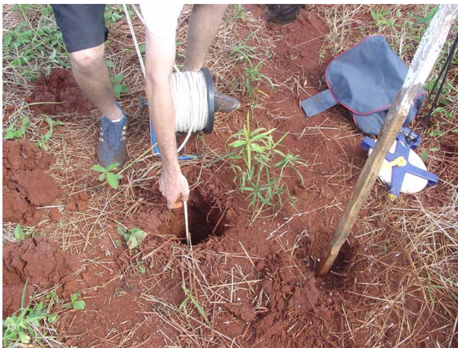
Foto 5. Medição do nível de água de furo de sondagem.
