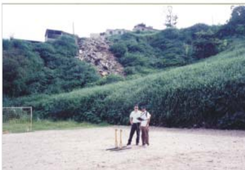
FOTO 6 - Geofísica pelo método GPR executada sobre o antigo lixão das fotos acima. Ao fundo observam-se depósitos recentes de lixo à meia encosta.
