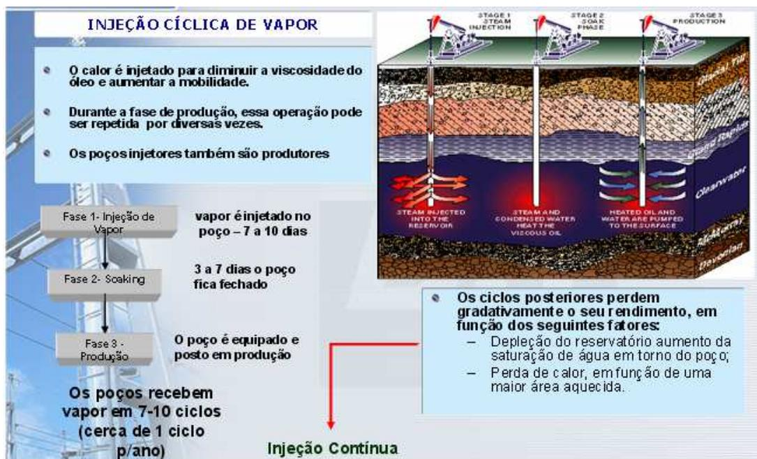
Figura 6. Modelo esquemático da injeção cíclica de vapor.
