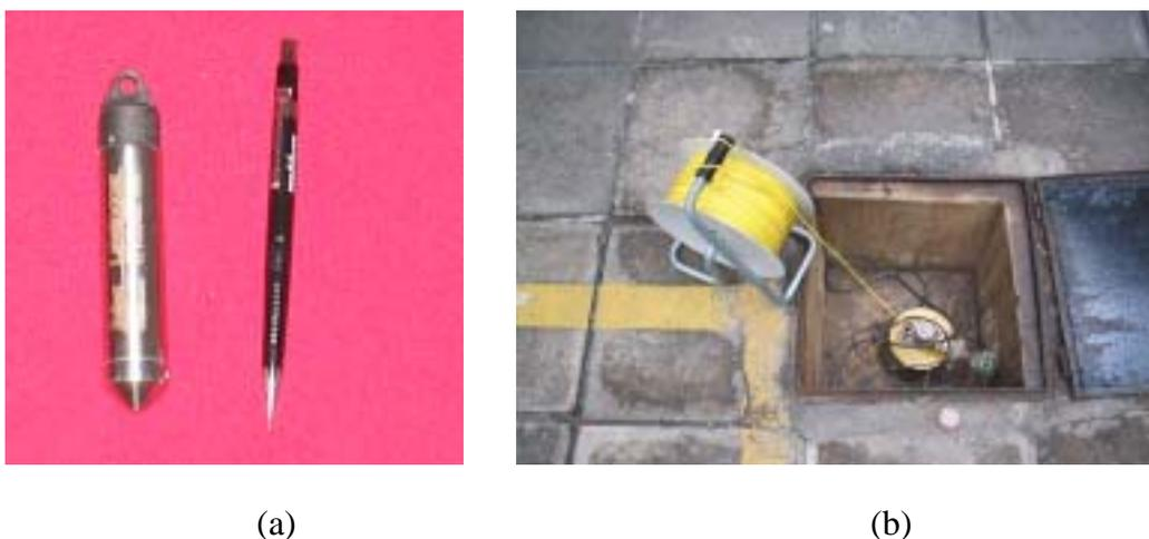
**Figura 3** – medidores de nível (a) automático e (b) manual.
