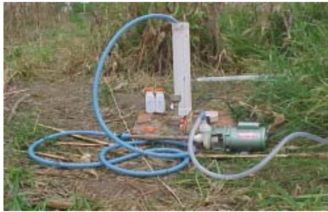
Figura 6 - Bomba centrífuga modificada para esgotamento dos poços.
