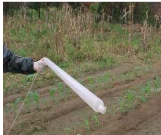
Figura 7 - Fotos do bailer (amostrador de água subterrânea utilizado no experimento).
