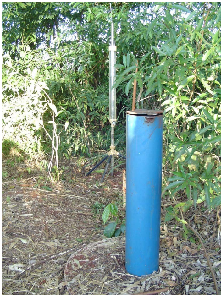
Figura 4 – PM 11 à frente e Permeâmetro Guelph ao Fundo.
