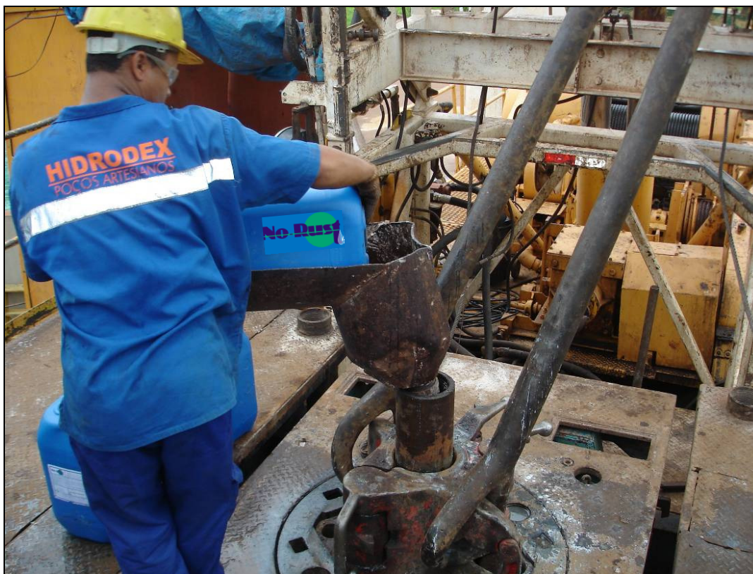
Figura 11. Aplicação inicial de 1.200 l de NO RUST.
