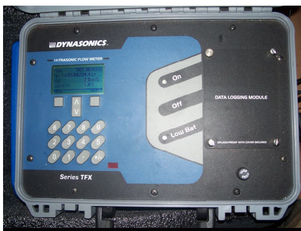
Foto 4 - Aparelho utilizado na medição da vazão do poço
