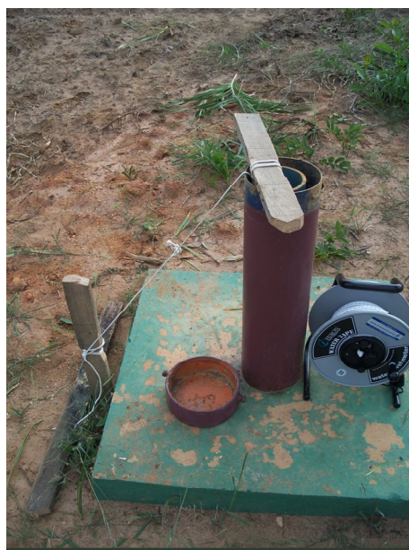
Fotos 1 e 2 – Sensor sendo instalado em um dos poços de observação.
