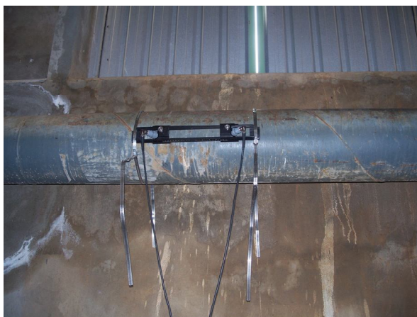
Foto 5– Sensores instalados para fazer a medição da vazão no cano pelo método de ultra-som
