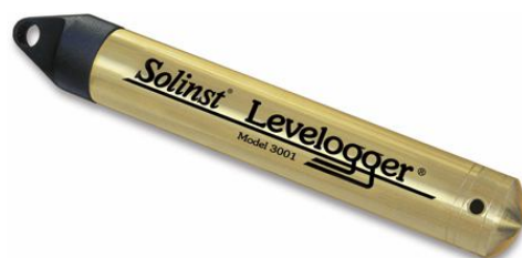
Figura 6– Sensor utilizado na medição do nível d'água durante os testes de bombeamento.
