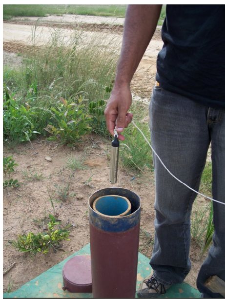
Fotos 1 e 2 – Sensor sendo instalado em um dos poços de observação.
