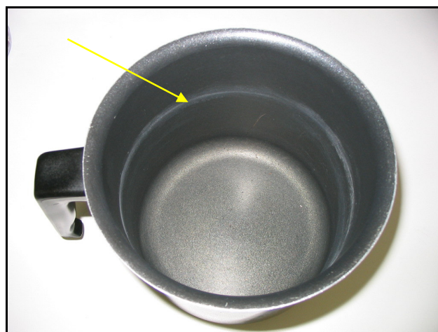
Fig. 12 – Utensílio de cozinha com marcas de precipitação, após fervura contínua de água.
